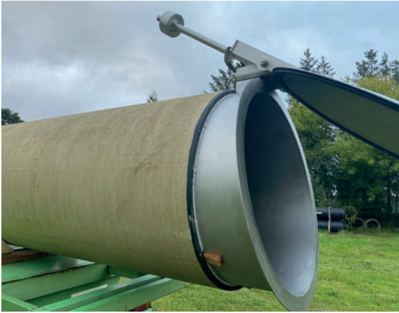
Abbildung 6.51: Moderne Klappe, die sich besser öffnen lässt und die Hechtmigration in Zuflüsse und angebundene Seen erleichtern könnte.
